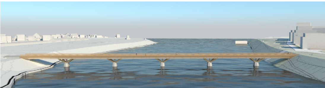
Skiss från alternativutredning - balkbro i trä - vald inriktning
