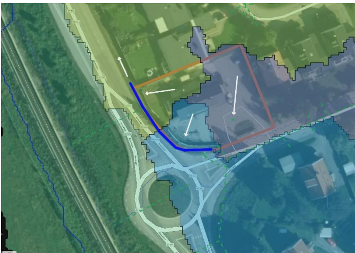
Figur 4. Befintliga dagvattenledningar illustreras med gröna streck. Vita pilar visar flödesriktningar för avrinning. Delavrinningsområdena illustreras med färgerna gult, lila och blått. Kommunalt dike visas som blå linje.
