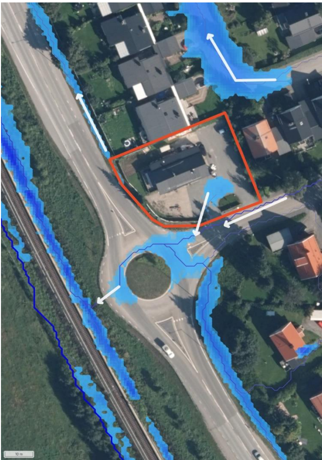
Figur 5. Karta över detaljplaneområdet i nuläget med flödesvägar och lågpunkter utifrån befintliga marknivåer med en regnbelastning om 43 mm, motsvarande 100-årsregn inklusive klimatfaktor. Vita pilar visar på flödesriktningar.
