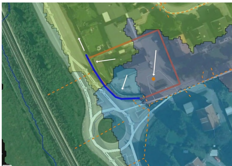
Figur 11. Befintliga dagvattenledningar illustreras med orangea streck. Vita pilar visar flödesriktningar för avrinning. Delavrinningsområdena illustreras med färgerna gult, lila och blått. Kommunalt dike visas som blå linje.
