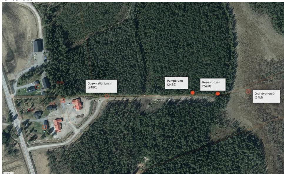
Figur 2. Översiktskarta och ortofoto med fastighetsgränser samt placering av huvudbrunn och reservbrunn (fylld cirkel), observationsbrunn samt ytligt grundvattenrör i myrmark (öppen cirkel) för nivåövervakning. Tappställen för provtagning från närliggande hushållsbrunnar är markerade (öppen kvadrat).
