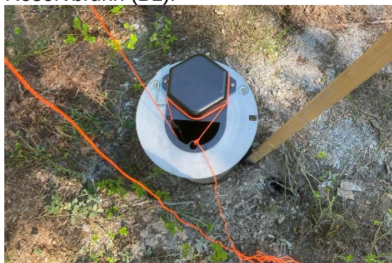
Figur 3. Huvudbrunn, reservbrunn och observationsbrunn med tillhörande utrustning. Observationsbrunnen förlängdes uppåt med PE-rör för att hantera artesiska förhållanden, för att kunna mäta grundvattennivå ovan markyta.
