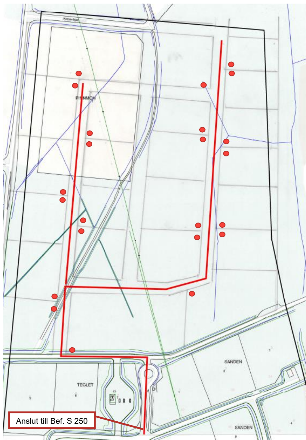
Figur 50. Alternativ ledningsdraging för ett LTA-system som samförläggas med vattenledning. Röd prick illustrerar pumpenhet. Utkast på plankarta enligt tidigare förslag.
