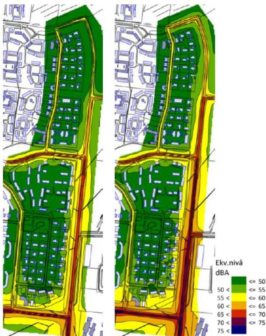
Figur 14. Ekvivalenta ljudnivåer 1,5 meter ovan mark vid fasad. Beräkning av baserad på dagens trafiksituation till vänster i bild respektive prognosåret 2040 till höger i bild. Källa: Trafikutredning, Trivector Traffic
