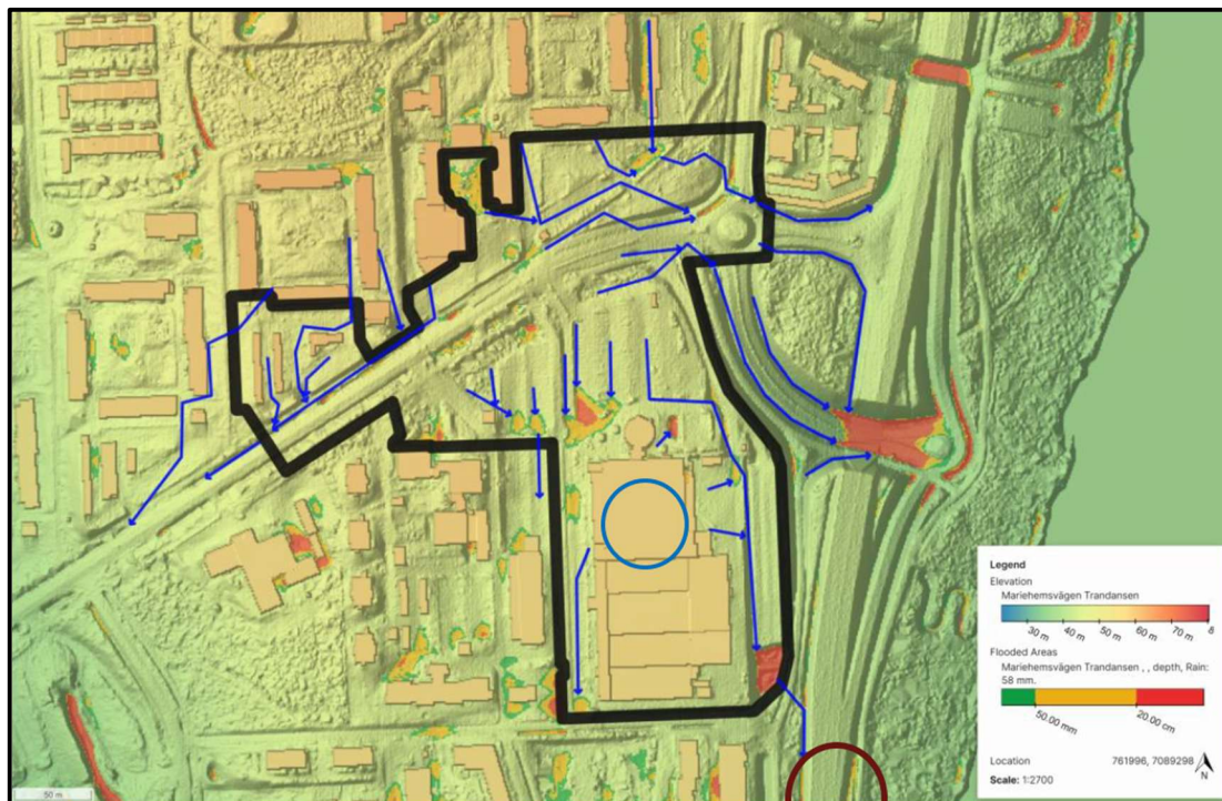
Figur 59. Befintliga flödesvägar och lågpunkter inom planområdet. Planområdets ungefärliga utbredning är markerat i svart. Källa: WSP 2024
